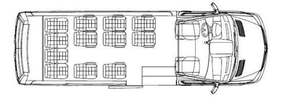
VEHICLE DETAIL: FORD TRANSIT HD WAGON OVERALL LENGTH — 263.9" WHEELBASE — 147.6" OVERALL WIDTH — 83.7" SHUTTLE-PLUG DOOR FORWARD FACING
